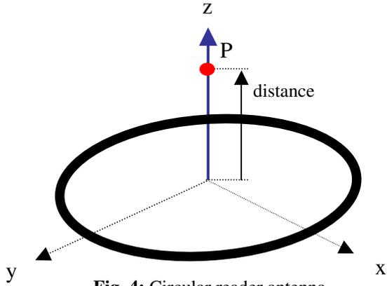
**Fig. 4:** Circular reader antenna.
